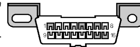
рис.11 Контакты колодки OBD2
